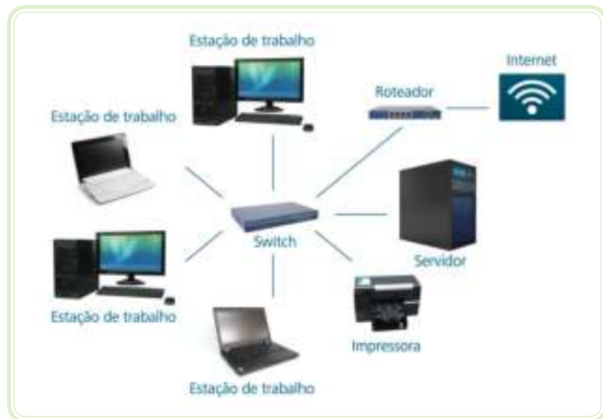
Figura 4.1: Esquema de uma rede de computadores
